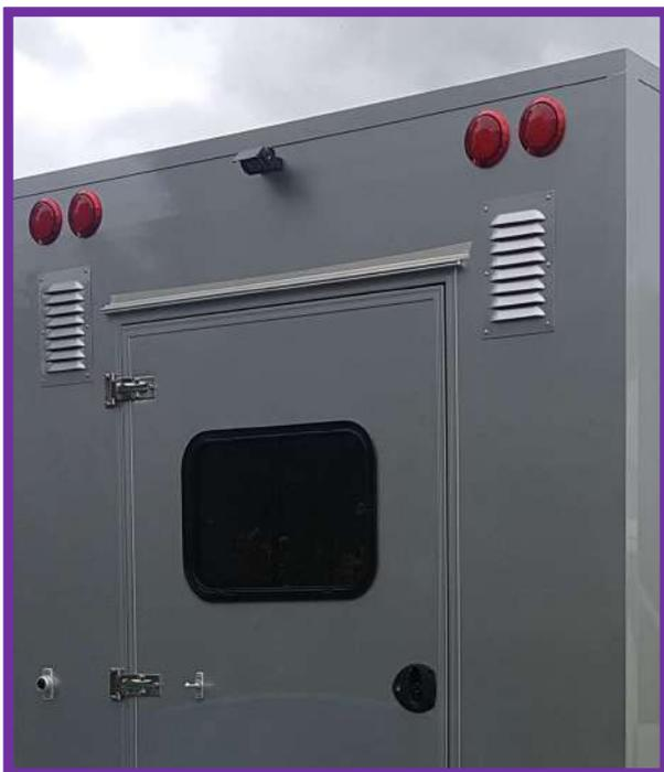
Face arrière avec une baie vitrée, 2 grilles d'aération, rappels de feux et caméra de recul
